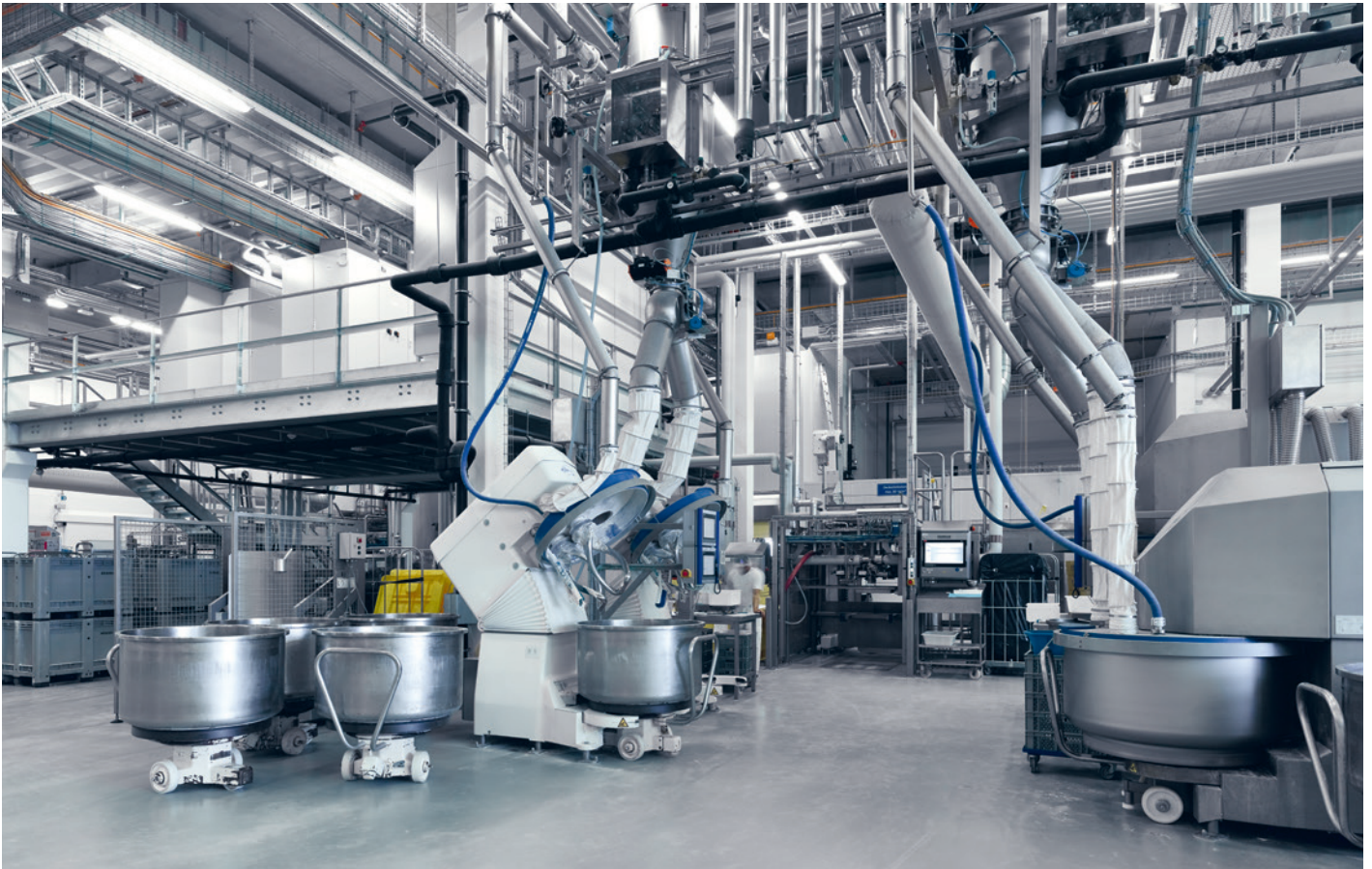
Kneter mit Kessel und Hebekipper am Anfang der Backlinie.
